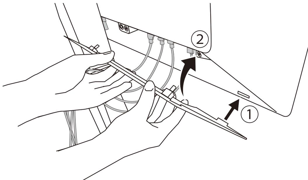
Ejemplo: Colocación de la tapa del conector (derecha)
