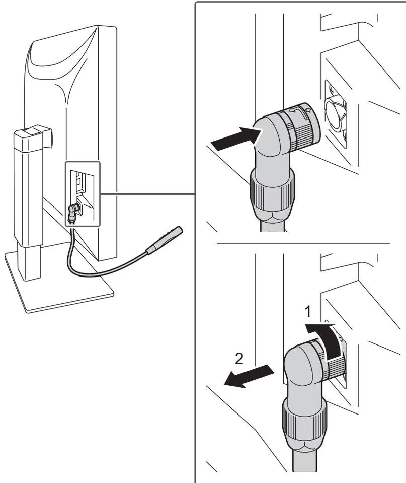
Para retirarlo, tire de él al mismo tiempo que gira la pieza que conecta con el monitor, en la dirección que se indica con el punto 1 en la ilustración.
