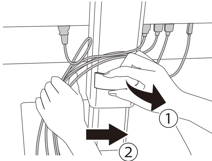
2. Coloque la tapa del conector.
