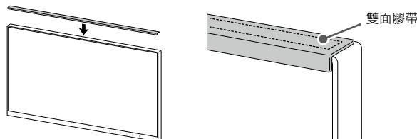
4. 將角落托架安裝至對準的位置，同時確認液晶面板表面和角落托架之間沒有空隙。
