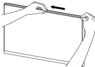
確認角落托架已穩固貼住。
