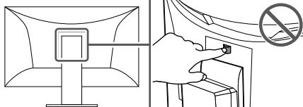
本產品配備一個鎖定按鈕，使顯示器固定在支架上。在其他情況下，因顯示器已從支架拆下，使用該鎖定按鈕可能造成產品損壞或人身傷害。
