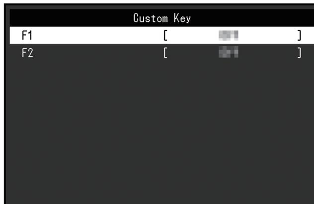
5. Используйте **▲ ▼** для выбора пользовательской клавиши, на которую следует назначить функцию, а затем нажмите **✓**.
