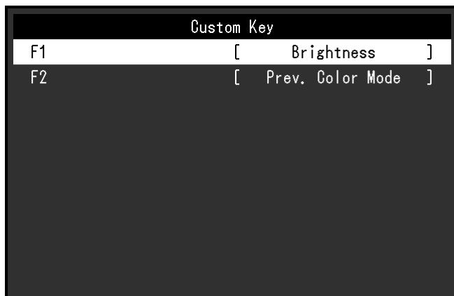
4. Используйте **▲** **▼** для выбора пользовательской клавиши, на которую следует назначить функцию, а затем нажмите **✓**.
