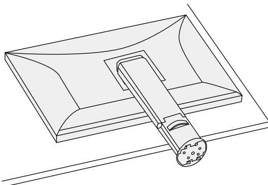
2. Прикрепите основание стойки на фиксатор стойки.
