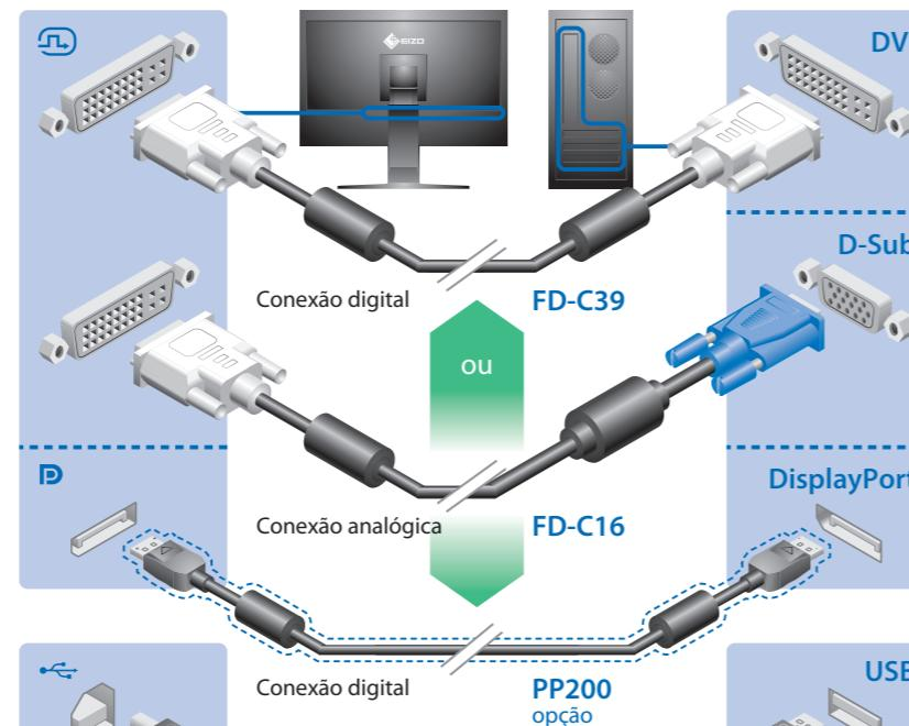
\*O cabo USB é necessário para a calibragem. Assegure-se de conectar o monitor e o PC com o cabo USB.
