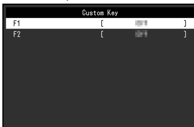
5. Используйте **▲ ▼** для выбора пользовательской клавиши, на которую следует назначить функцию, а затем нажмите **✓**.
