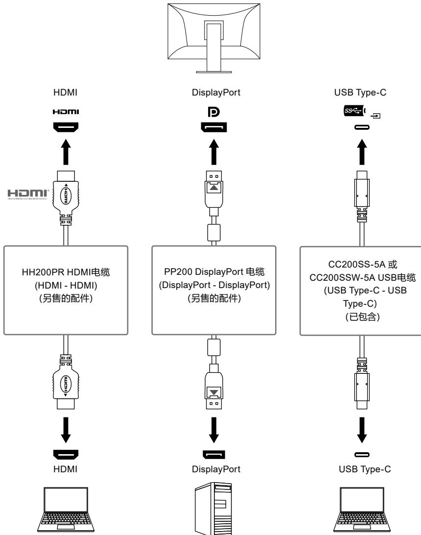
将两个 PC 连接到同一显示器时, 您可以使用 USB 端口关联输入信号, 以便可以通过在两者之间进行切换来从两个 PC 使用连接到显示器的 USB 设备。有关详细信息, 请参阅 “KVM” (第26页)。
