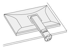
2. Placez le support du pied de manière à ce que l'étiquette noire (FRONT) soit alignée comme sur le schéma, et installez le support du pied sur la partie inférieure du pied.
