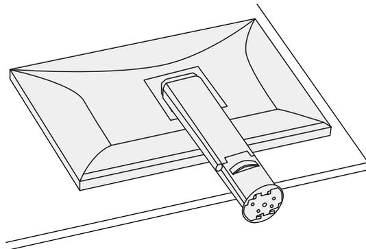
2. 固定底座，以便使背面标签 ( FRONT ) 对齐 (如图所示)，然后将底座连接到底座支架。
