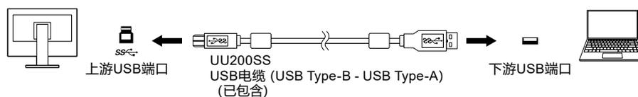
2. 请将外部USB设备连接至显示器上的下游USB端口 (第9页)。
