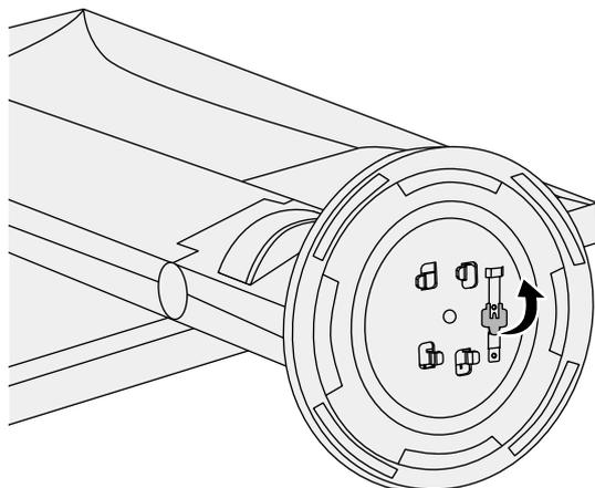
3. 按逆时针方向旋转支架底座可卸下支架底座。
