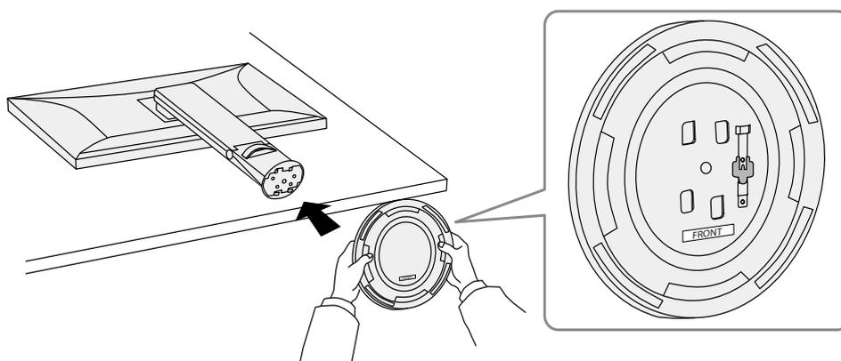
3. Поверните основание стойки по часовой стрелке до щелчка.
