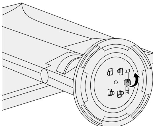
3. Поверните основание стойки против часовой стрелки, чтобы отсоединить его.
