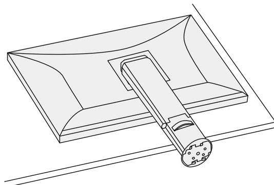
2. Прикрепите основание стойки на фиксатор стойки.
