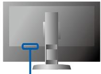
El portacables de la parte posterior del soporte mantiene los cables recogidos.
