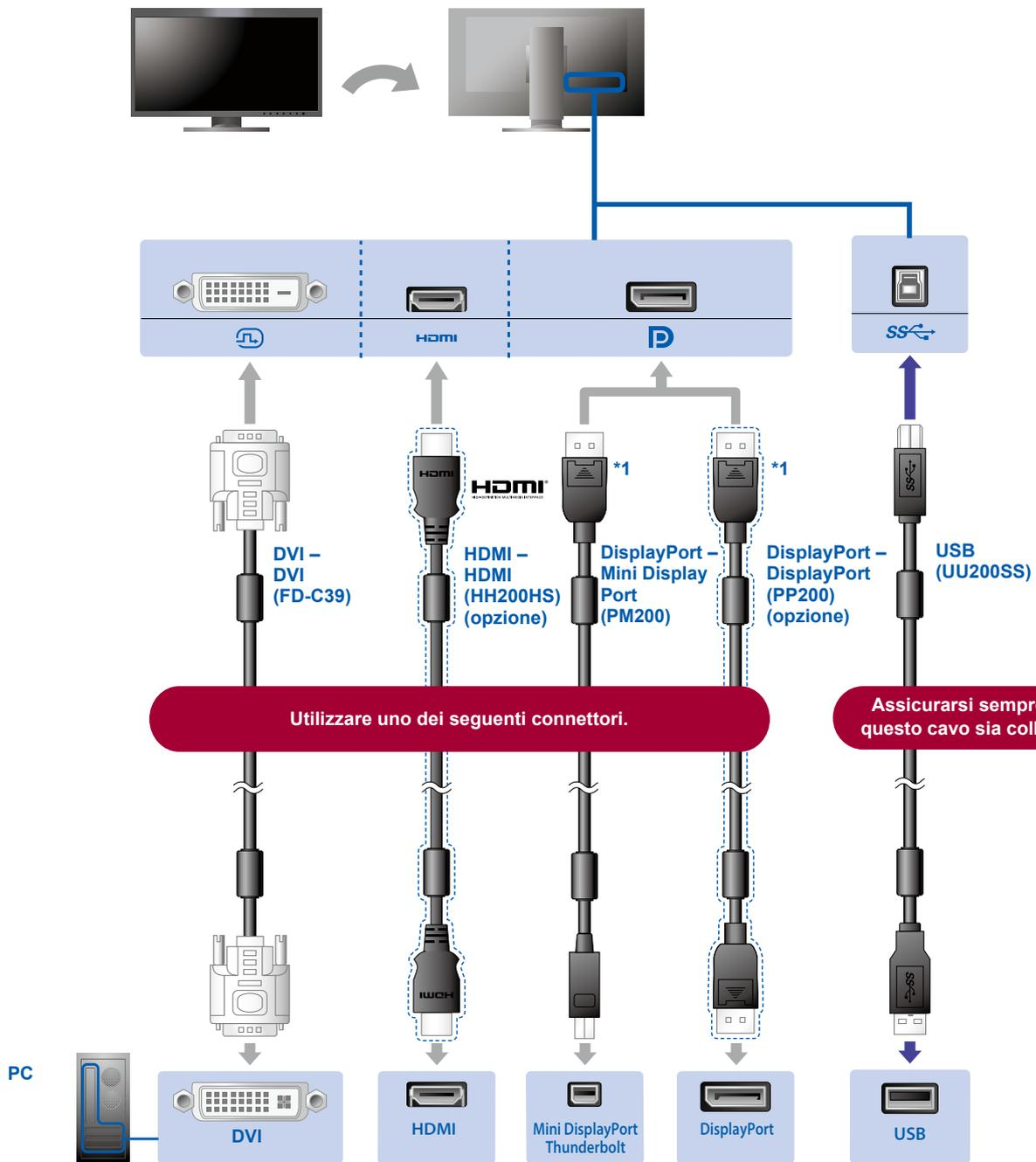
\*1 Durante la rimozione del cavo DisplayPort, premere sul segno ≡ sull'estremità del cavo.
