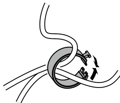
3. 保持电缆固定器闭合的同时将电缆固定器安装到支架上。
