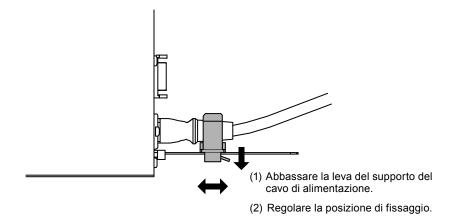
3. Fissare il supporto del cavo di alimentazione per evitare la caduta del cavo di alimentazione.
