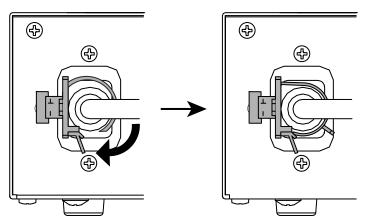
\*Controllare che il supporto del cavo di alimentazione sia fissato.
