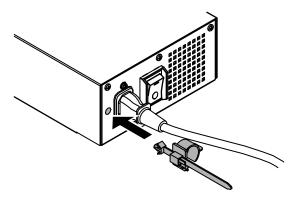
2. Regolare la posizione per fissare il supporto del cavo di alimentazione consultando la figura illustrata di seguito.
