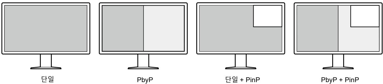
모니터는 1 개의 DisplayPort 케이블만 사용하여 PbyP 모드로 이미지를 표시하는 One Cable PbyP 기능을 제공합니다.
