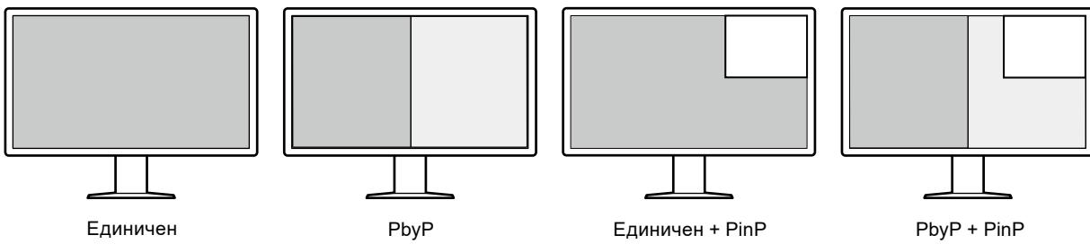
Мониторът предоставя функцията One Cable PbyP, която показва изображения в режим PbyP само с помощта на един кабел DisplayPort.
