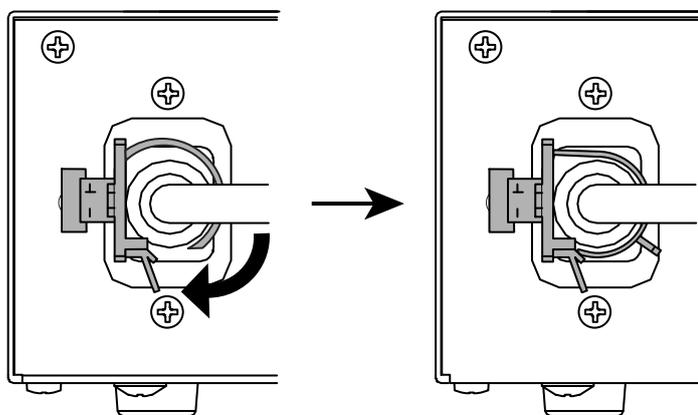
\*请检查电源线固定器是否已固定。
