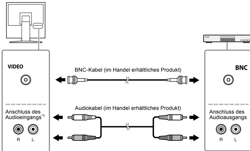
\*1 Der Monitor ist mit einem einzelnen Audioeingangsanschluss ausgestattet, um entweder einen PC oder ein Videoanzeigergerät anschließen zu können. Unabhängig vom Eingabegerät gibt der Monitor einen Ton aus.
