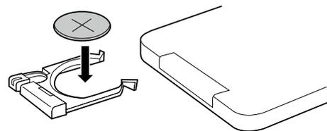
**3.** Setzen Sie die Batterieabdeckung soweit ein, bis es klickt.
