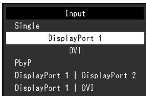
在双画面模式中,“DisplayPort 1” (D<sub>1</sub>)输入信号显示在屏幕左侧,“DisplayPort 2” (D<sub>2</sub>)或“DVI”输入信号在右侧。
